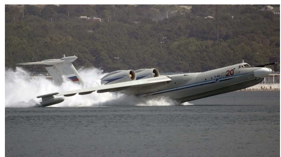
IL BERIEV A-40 ALBATROS è il più grande aereo anfibo multiruolo del mondo. Si tratta di un bimotore a getto progettato dalla Beriev per la guerra anti-sommergibile. Il progetto venne sospeso dopo che soli due prototipi vennero costruiti, a causa del collasso dell'Unione Sovietica.
