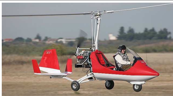
L'autogiro ELA-07-CASARRUBIOS-SPAIN è un'aerodina ad ala rotante dove, a differenza dell'elicottero, il motore non aziona il rotore principale, ma genera una spinta come per un aeroplano. Il rotore principale quindi non è messo in moto dal motore, ma dal flusso d'aria che lo investe.
