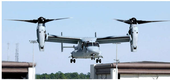
Il convertiplano BELL-BOEING V-22 OSPREY decolla come un elicottero ma vola come un aereo convenzionale.
