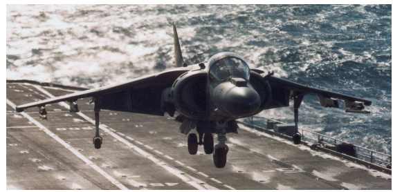
L'HAWKER SIDDELEY HARRIER è stato il primo esempio di caccia a decollo verticale e venne costruito in Gran Bretagna.
